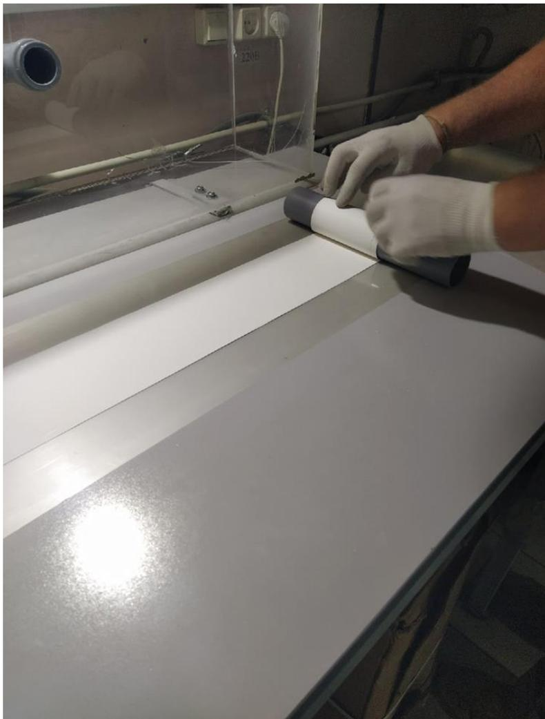
Методом пленочного литья были изготовлены пленки из  $\text{MgAl}_2\text{O}_4$  и из  $\text{ZrO}_2$ , задача – определить коэффициенты усадки данных пленок при спекании.
