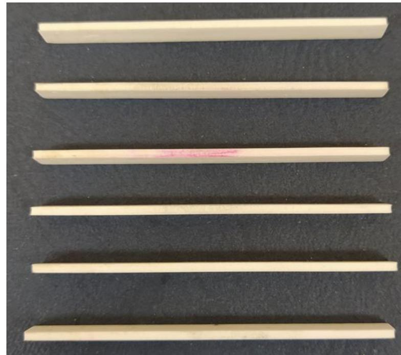
***В образцах наблюдался выход пузырей с ребер и торца в местах соединения диоксида циркония и шпинели, что говорит об отсутствии герметичности.***
