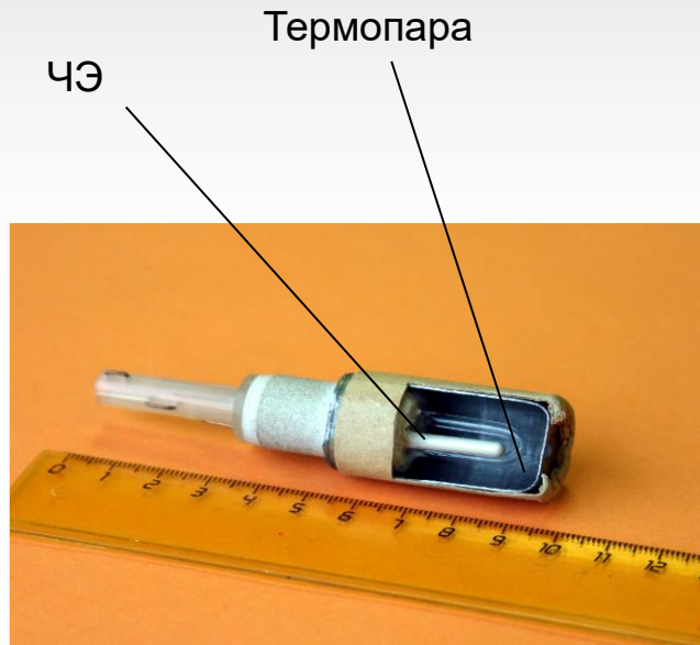
Внешний вид датчика окисленности стали
