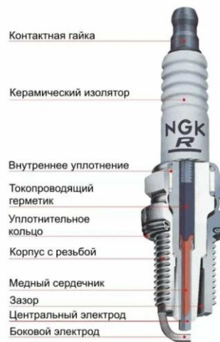
Устройство свечи зажигания
