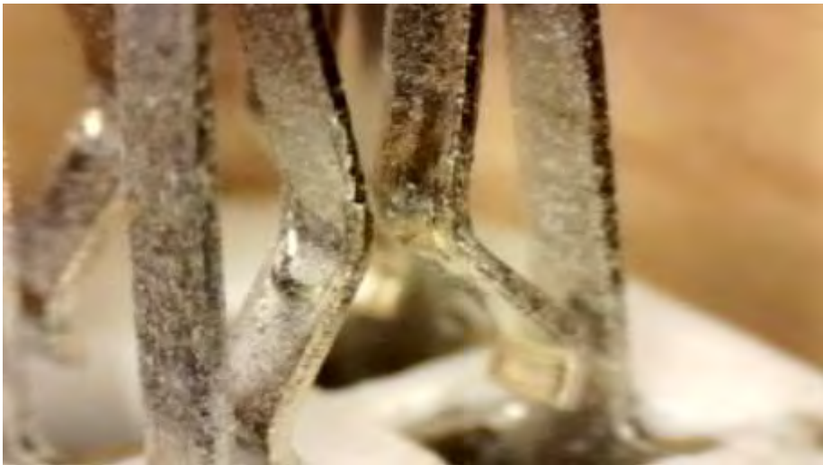
Коррозия и износ контактной группы датчика кислорода
