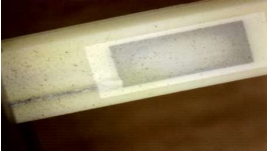
Повреждения дорожек, подходящих к электроду
