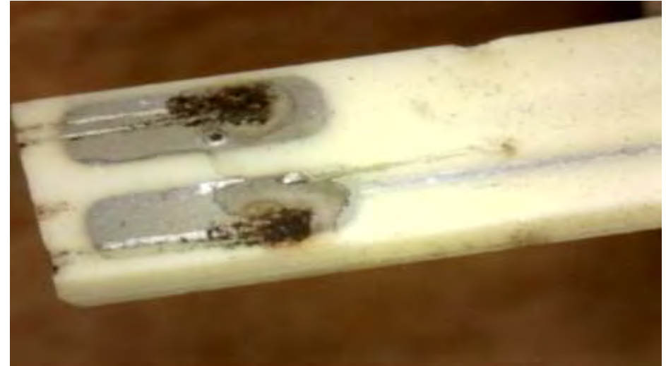
Повреждения контактных площадок
