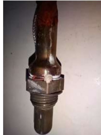
ДК DELPHI (с накачкой) с установленной термопарой
