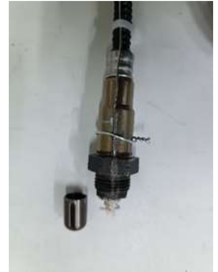
ДК BOSCH (с атмосферной камерой) с установленной термопарой и подготовленным к монтажу колпачком типа DELPHI
