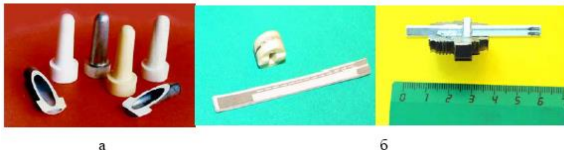
Керамика ZrO_2-Y_2O_3 для трубчатых (а) и планарных (б) датчиков кислорода
