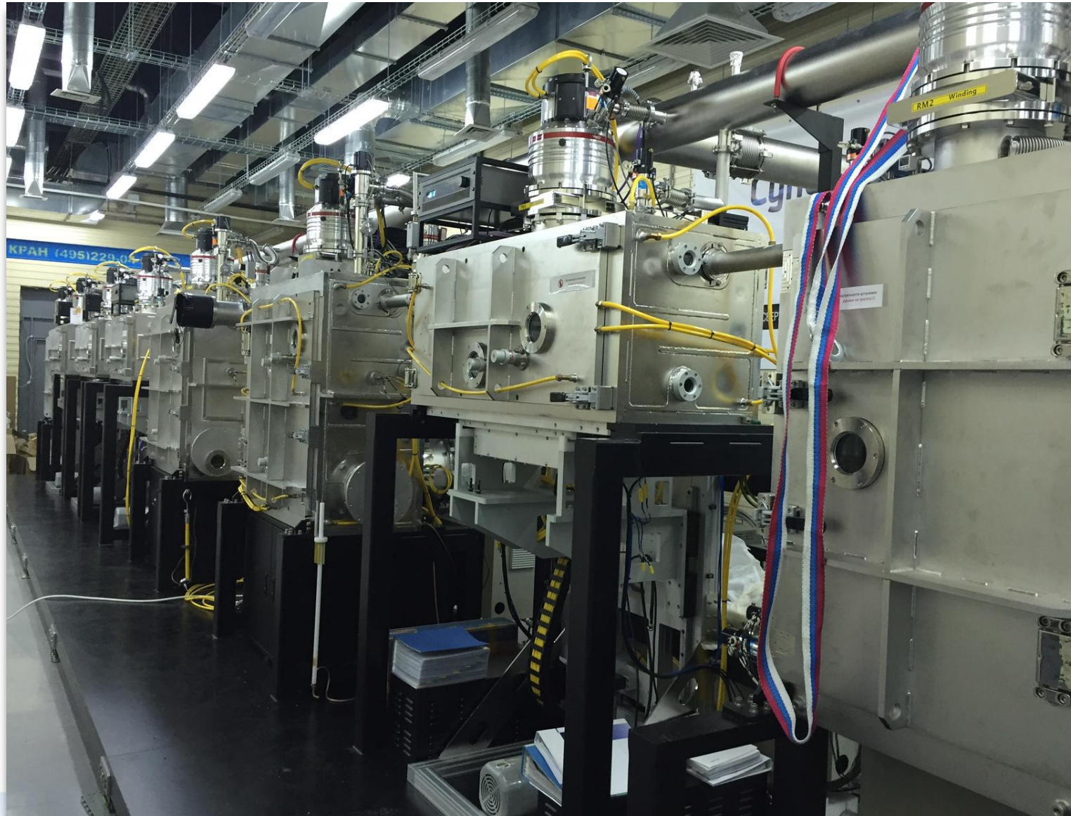
Линия из последовательных вакуумных камер для получения ленты с буферными слоями по технологии IBCD.
