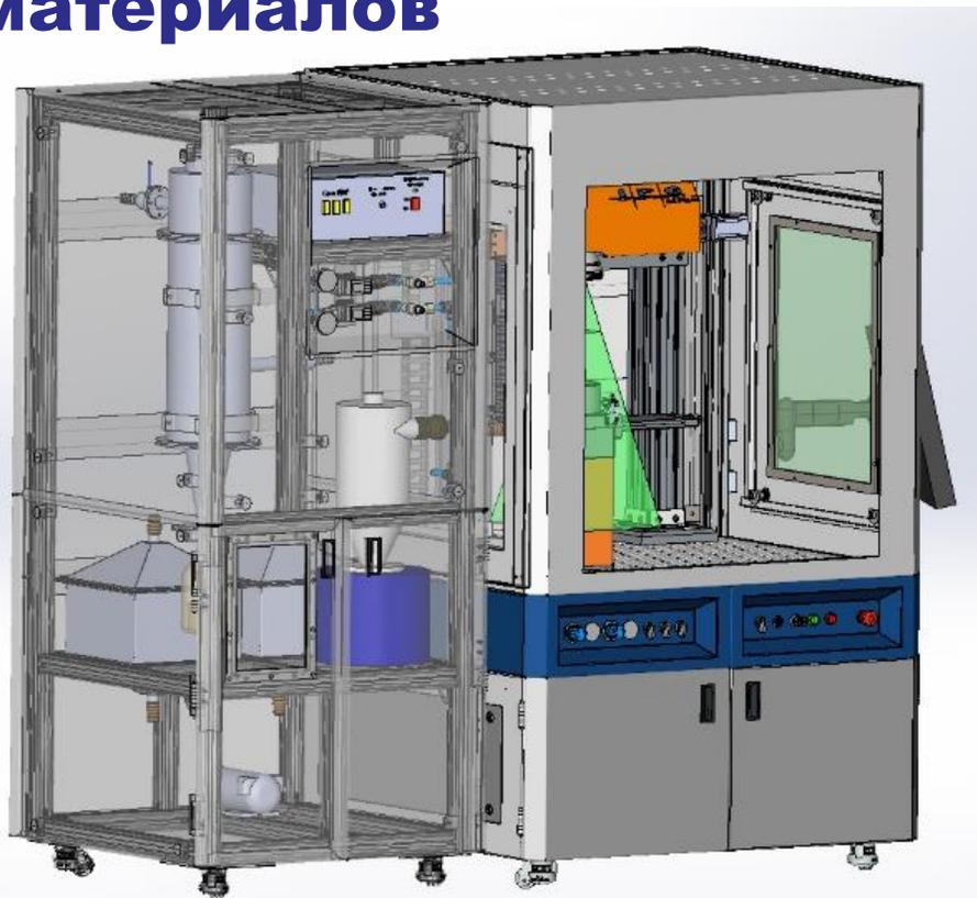
*Установка синтеза лазерного нанопорошка
