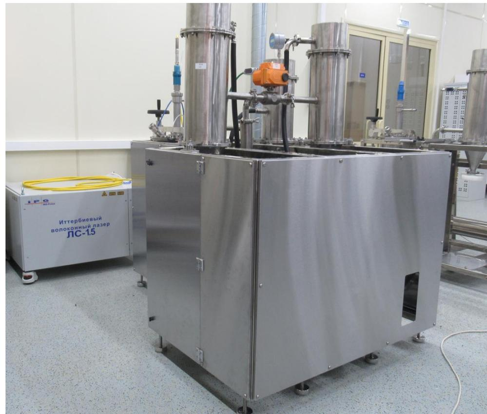
*Установка синтеза лазерного нанопорошка
