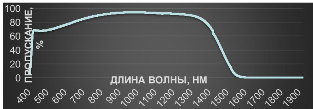
Спектр пропускания керамики  $Tb_2O_3$  из лазерного нанопорошка (95%)
