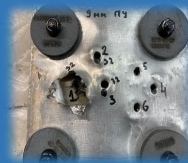
**Испытания бронепанели: 6 выстрелов; винтовка СВД калибр - 7,62 мм; патрон- 7 БЗ-3 с пулей Б-32; дистанция 10 м (на фото - фронтальная сторона; тыльная – без пробития)**
