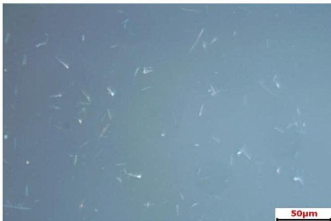
Фотография порошка диоксида циркония масштабом 50 мкм, снятая в темном поле на МЕТАМ ЛВ-41
